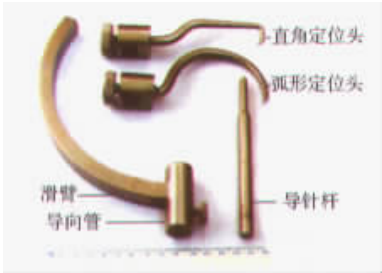
图 1 滑臂式导向器结构图
